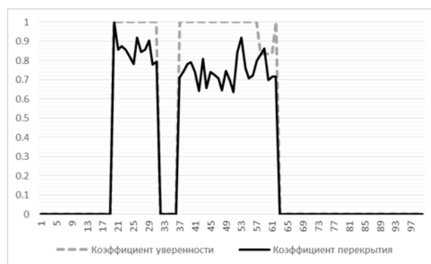
Рис. 5: Зависимости коэффициента уверенности и точности сопровождения от кадра для произвольной видеопоследовательности для Struck (коэфф. корреляции 0.84)
