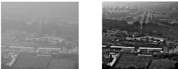
Рис. 9: Исходное изображение, полученное в условиях тумана (слева) и результат применения предложенного метода преобразования (справа).
