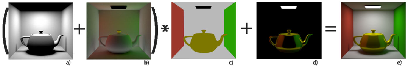
Рис. 2. Вычисление цвета финального изображения: а) интенсивность первичного освещения; б) интенсивность вторичного освещения; в) цвет текстуры; д) отражённое освещение; е) финальное изображение
