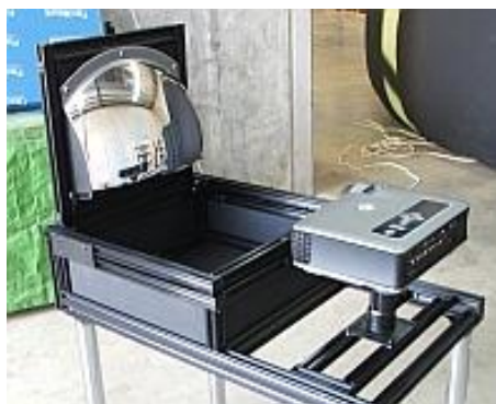
Рис. 1 Проектор и сферическое зеркало
