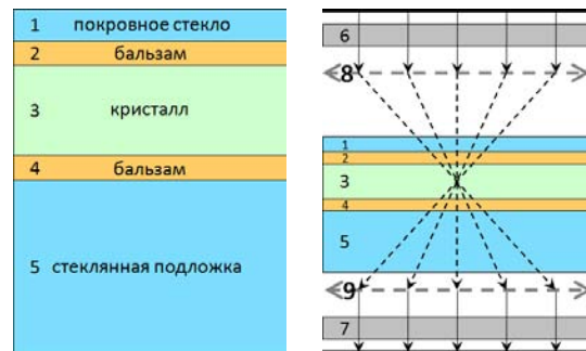
Рис. 8. Структура петрографического шлифа (слева) и схема распространения лучей при изучении шлифа методом коноскопии
