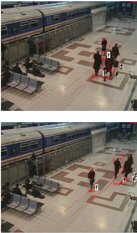
Рис 7: Индивидуальное сопровождение объектов в момент встречи (наверху) и после встречи (внизу) при помощи корреляционного алгоритма. Фрагмент видео из PETS [9].
