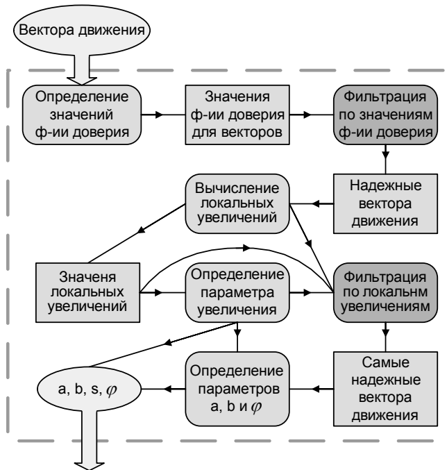
Рис. 4. Блок-схема алгоритма для четырехпараметровой модели глобального движения
