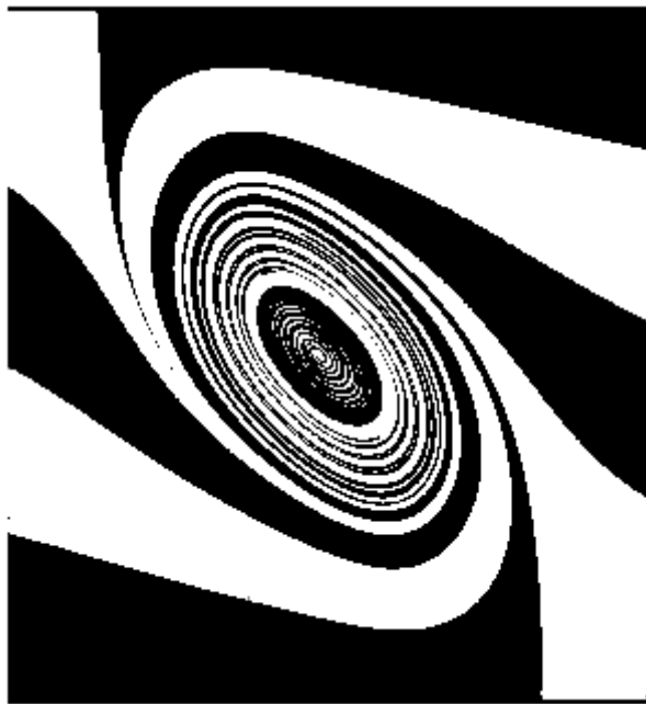
Рис. 6. Изображение вихря КЦ, построенное методом 'светового ножа', вид вдоль оси x .
